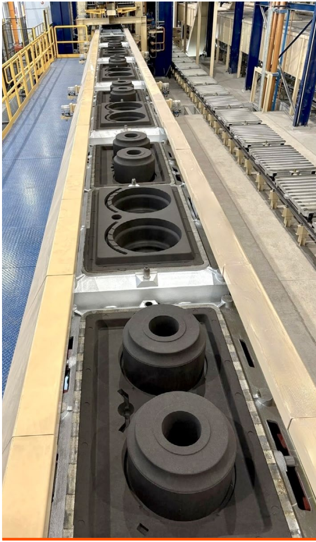
Linea di Formatura per nuova fonderia in Messico
