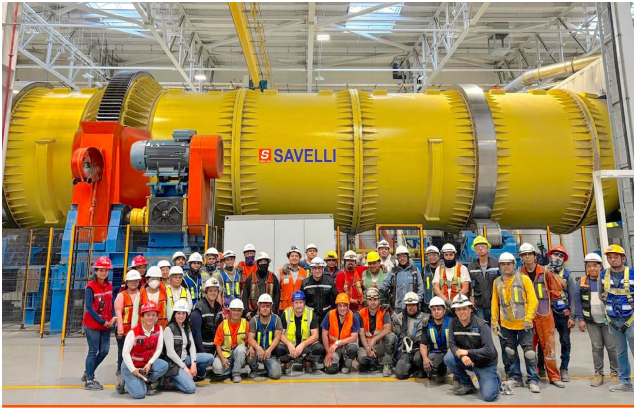
Savelli Technologies S.r.l. - Tamburo Rotante Distaffatore per Raffreddamento Terra e Getti per nuova fonderia in Messico
