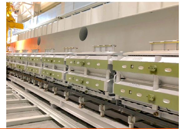
Savelli Technologies S.r.l. - Linea di formatura orizzontale in staffa per la produzione di blocchi motore e testate cilindri per camion in Svezia
