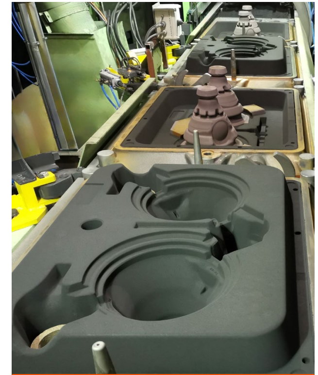
Linea di formatura SAVELLI per una fonderia in Corea del Sud
