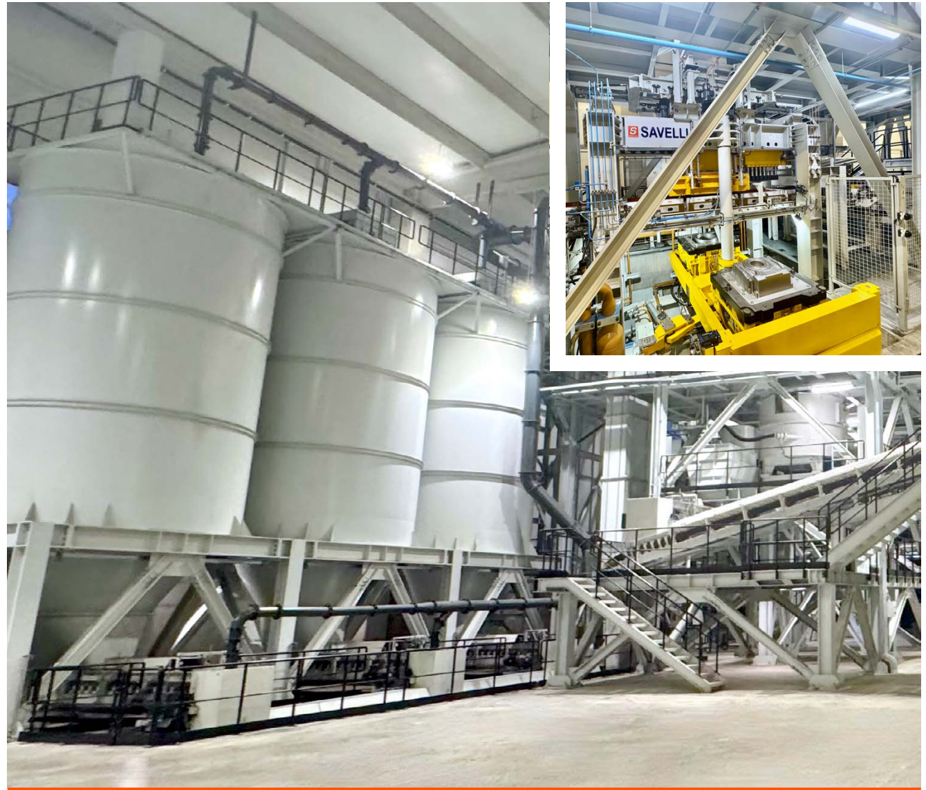
Linea di formatura F1 Formimpress® e relativo impianto di preparazione e recupero della terra per la fonderia PMP, Bosnia
